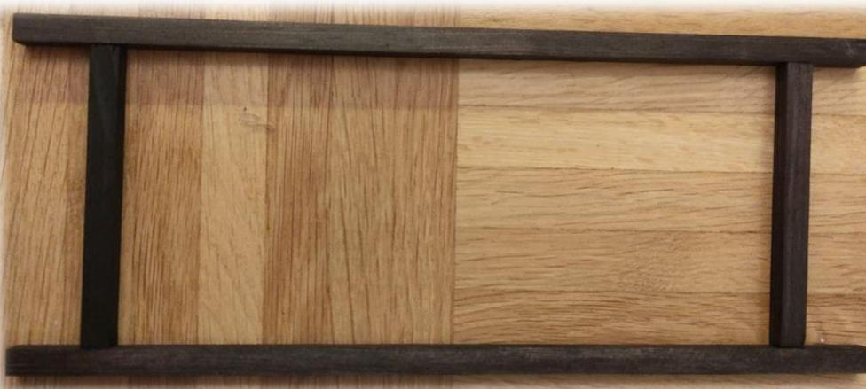
Im nächsten Schritt werden die Rahmen verbunden. Dazu werden alle vier Rahmen mit insgesamt 3 x 2 Scharnieren verbunden. An einer Seite kommt eine zusätzliche Leiste zum Einsatz auf dieser wird die Öse des Riegelhaken befestigt. Auf der gegenüberliegenden Seite wird der Eigentliche Riegelhaken befestigt. Auch hier empfiehlt sich wieder die Nutzung einer selbstgebauten Lehre.
